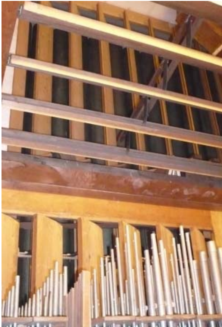
61. kép: 425 A heidelbergi Stadthalle Voit- orgonájának redőnyében készült felvételen látszik a II. manuál szekrényének terem felé nyíló két redőnyfala. A lamellák között a Generalschweller rekonstruált levelei láthatók.
