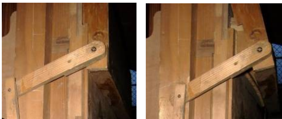
40–41. kép: 341 A Physharmonika hangerejét tompító „tető” csukott és nyitott helyzetben
