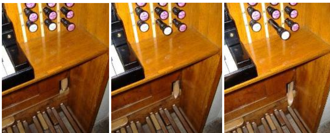
52–54. kép: 384 A redőnymozgató talp mai formája. A szerkezet lábbal és kézzel egyaránt irányítható, a két kapcsoló együtt mozog
