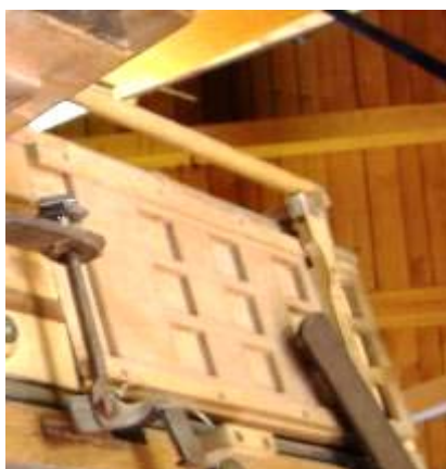
33. kép: 285 Kotykiewicz-harmónium kettős rácsozatú forte-szerkezete, mely hasonlóságot mutat a „kettős tetejű” redőnyvel.
